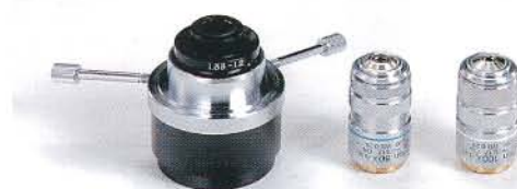
暗視野用コンデンサーと絞り付き対物レンズ
