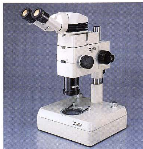
COX 同軸反射照明装置付RZT透過照明スタンドモデル
