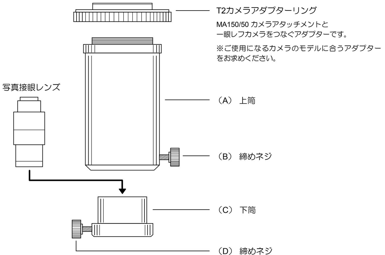
1. 締めネジ（B）をゆるめて、上筒・下筒を分離してください。
