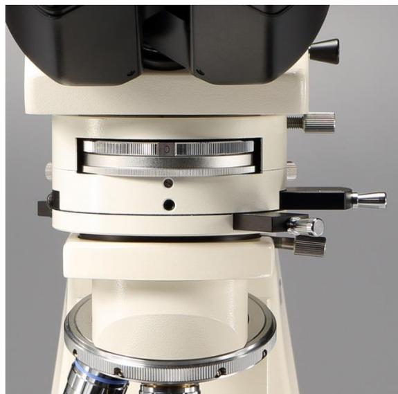
2) レボルバーを回して分散(ディスパージョン)対物レンズ 10X を光路に入れ、コンデンサーの外枠環を回してポジション「Ph1」に合わせます。
